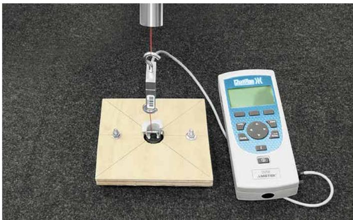
Тестирование прочности фиксаторов для ковриков
