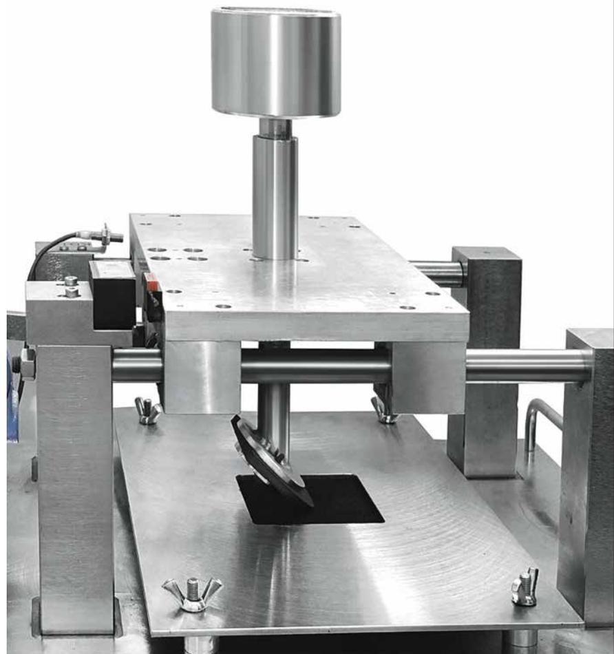
Роботизированное устройство для проведения «испытания каблучком»
