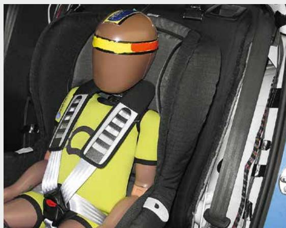
\* Допускается устанавливать детское кресло на переднем пассажирском сиденье против движения (спинкой вперёд) только при отключённой правой фронтальной подушке безопасности! Подробности — в Руководстве по эксплуатации.
