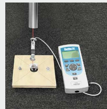
Тестирование прочности фиксаторов для ковриков
