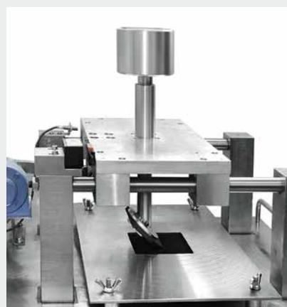
Устройство для проведения «испытания каблуком»
